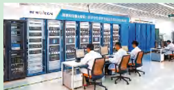
和睦系统FirmSys 中国首个具有自主知识产权的核级数字化仪控系统(DCS)。
